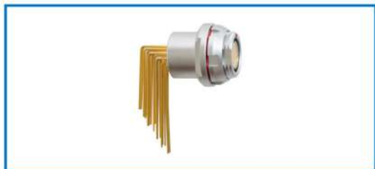
ZLN 插座真封型插座, 长弯针插座 PCB 板结, 外螺母固定结构, 半圆金属防止误插 (弯针型)
