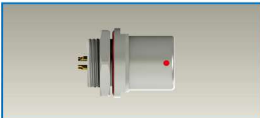
ZHN 凸出式尾部内螺母固定插座,内螺母固定(前面板安装),内部半圆金属片定位,防止误插,防护等级(IP68)
