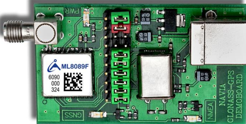
Рис. 3. Внешний вид платы демонстрационной для приемника ML8089F (не в масштабе 1:1).
