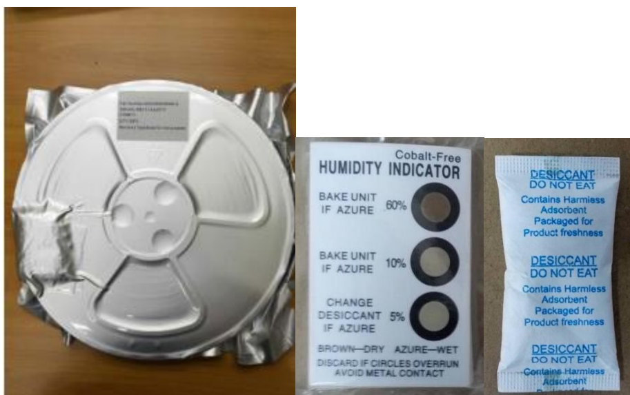
Рис.17. Упакованная катушка с лентой. Индикатор влажности и пакет с влагопоглотителем.
