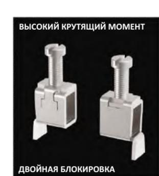
выдерживать более высокий момент затяжки. Контактный зажим подвергается термообработке для повышения твердости и прочности. Затем он оцинковывается и пассивируется до более высокой толщины покрытия по сравнению с толщиной, принятой в обычной практике. В связи с этим, винтовые зажимы *'elmex'* обладают повышенной устойчивостью к обычной атмосферной
