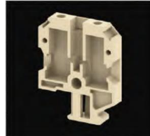
Нижняя U-образная поверхность имеет зазубрины, которые обеспечивают надежный захват проводника при затяжке. В выступах сверлятся отверстия с нарезкой накатанной резьбы по одной оси на специальном станке, что обеспечивает более высокую механическую прочность резьбы и позволяет
