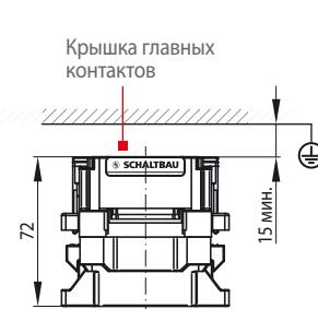
**i** Для контакторов C310S/150, C310S/300 и C310S/500 минимальное расстояние до заземленных частей оборудования или частей находящихся под напряжением должно быть 15 мм.
