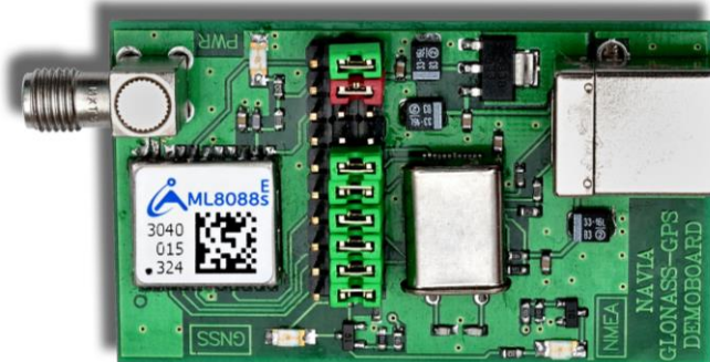
Рис. 4. Внешний вид малогабаритной демонстрационной платы для приемника ML8088sE (не в масштабе 1:1).
