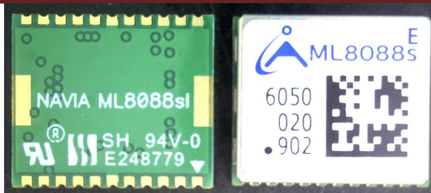
Рис. 2. Внешний вид приемника навигационного ML8088sE (не в масштабе 1:1)
