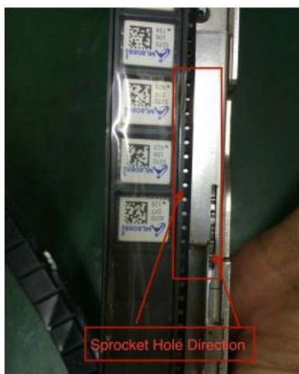
Рис.16. Направление размотки ленты и положение первого вывода приемника ML8088sE в ленте.
