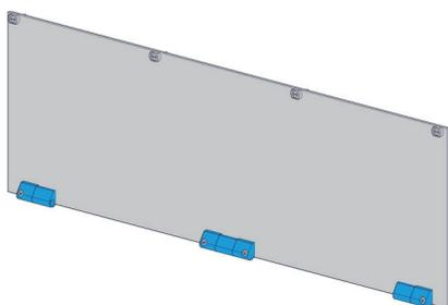
**Откидная / поворотная с шарнирными элементами**
