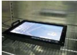
Рис. 11. Работа при повышенной температуре
