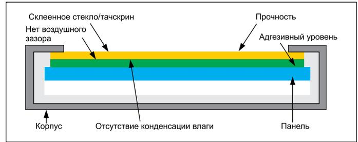
Рис. 5. Монитор, выполненный по технологии Optical bonding
