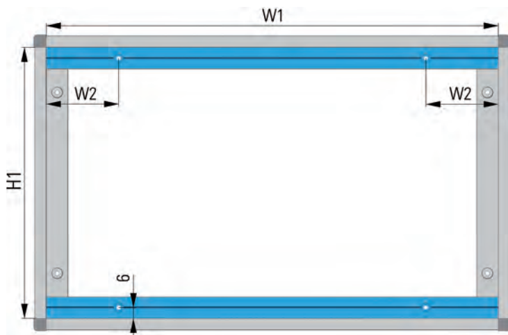
Главный вид корпуса с профилем рамы глубиной D1 = 130 мм
