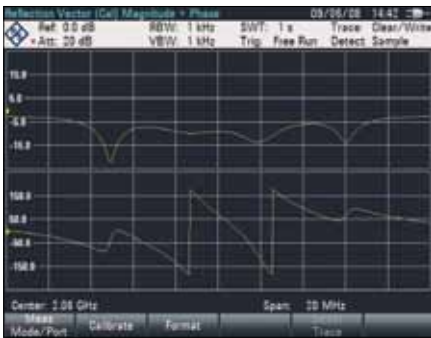
Векторный анализ электрических цепей: отображение амплитуды и фазы
