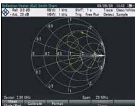
Векторный анализ электрических цепей с применением диаграммы Вольперта-Смита
