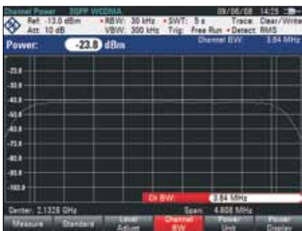
Измерение мощности в канале
