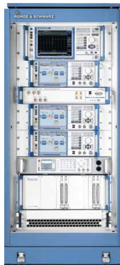
Пример конфигурации: трехканальная система для моноимпульсного радара.
