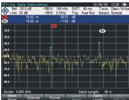
Измерение расстояния до места повреждения (DTF)
