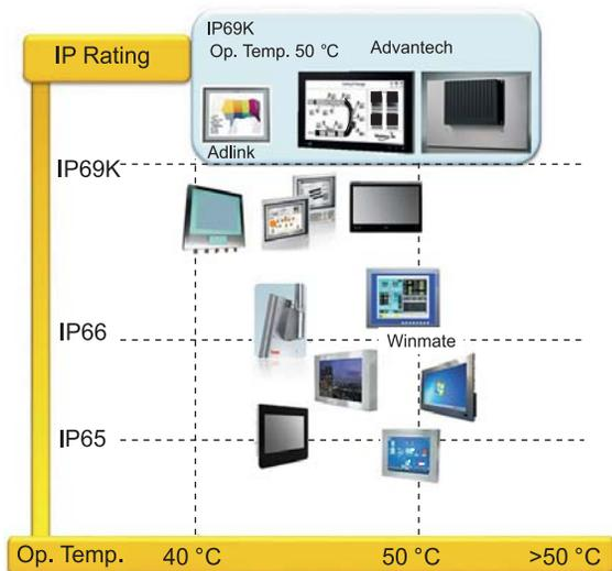
Рис. 1. Варианты исполнения современных панельных компьютеров в зависимости от IP и температуры окружающей среды
