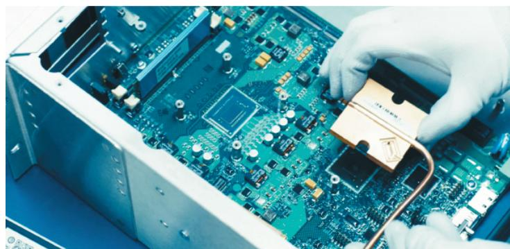
**РИС. 2. ◀** Использование теплопроводов и тепловых трубок в системе охлаждения исключает ненадежные и часто отказывающиеся вентиляторы
