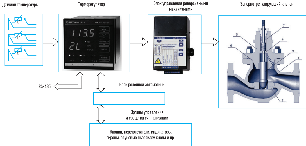
РИС. 5. ◀ Структурная схема локальной АСУ ТП с реализацией ПИД-регулирования для электроприводной арматуры
