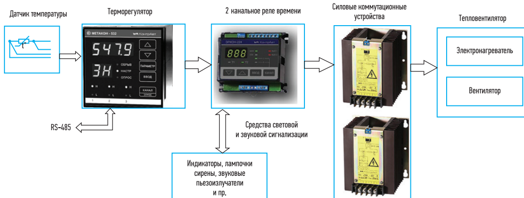
РИС. 3. ► Структурная схема локальной АСУ ТП с реализацией поддержания температуры в заданный интервал времени
