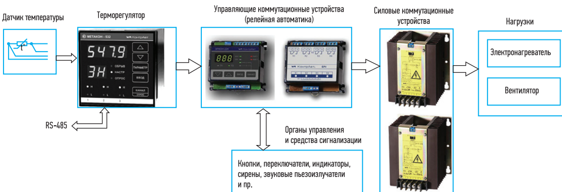
РИС. 2. ◀ Структурная схема локальной АСУ ТП с реализацией одноканального двухпозиционного регулирования
